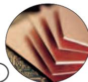
3 Soporte de la fuente de alimentación en **FR4**, sintetizada a partir de una **fibra de vidrio** impregnada a altas temperaturas y presión, con **resina epoxi**. Este material aislante presenta una excelente resistencia mecánica y dieléctrica especial para ambientes **húmedos y/o agresivos**.
